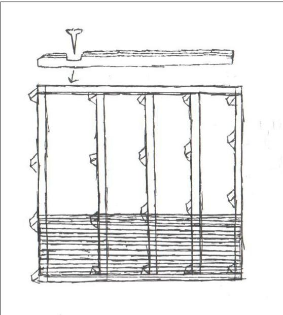
Fig. 3. Illustration af bundrammebjælkerne og montage af gulvbrædder. Første række af væggbjælker skrues fast til bundrammen.
