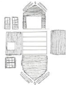
Abb. 1. Teile an allen vier Hausseiten verteilen.
