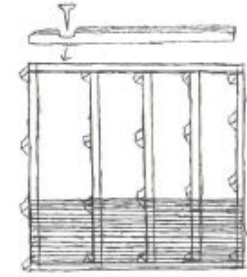
Abb. 3. Fundamentrahmen, Bodenbalken und erste Bohlenlage.
