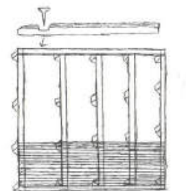
Fig. 3. Bundramme, gulvstrøer og første lag vægbrædder.
