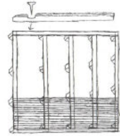
Abb. 3. Fundamentrahmen, Bodenbalken und erste Bohlenlage.
