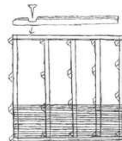
Fig. 3. Bundramme, gulvstrøer og første lag vægbrædder.
