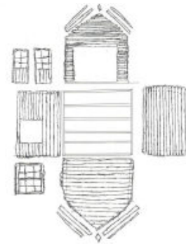
Abb. 1. Teile an allen vier Hausseiten verteilen.
